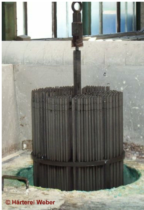
Charge wird im AB 1 Salzbad abgekühlt
